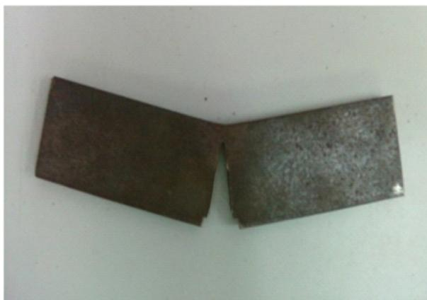
Figura 3.14: Probeta de dobléz después de realizado el ensayo en la máquina de pruebas universales
