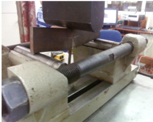
Figura 3.12: *Probeta deformada por propagación de la grieta*
