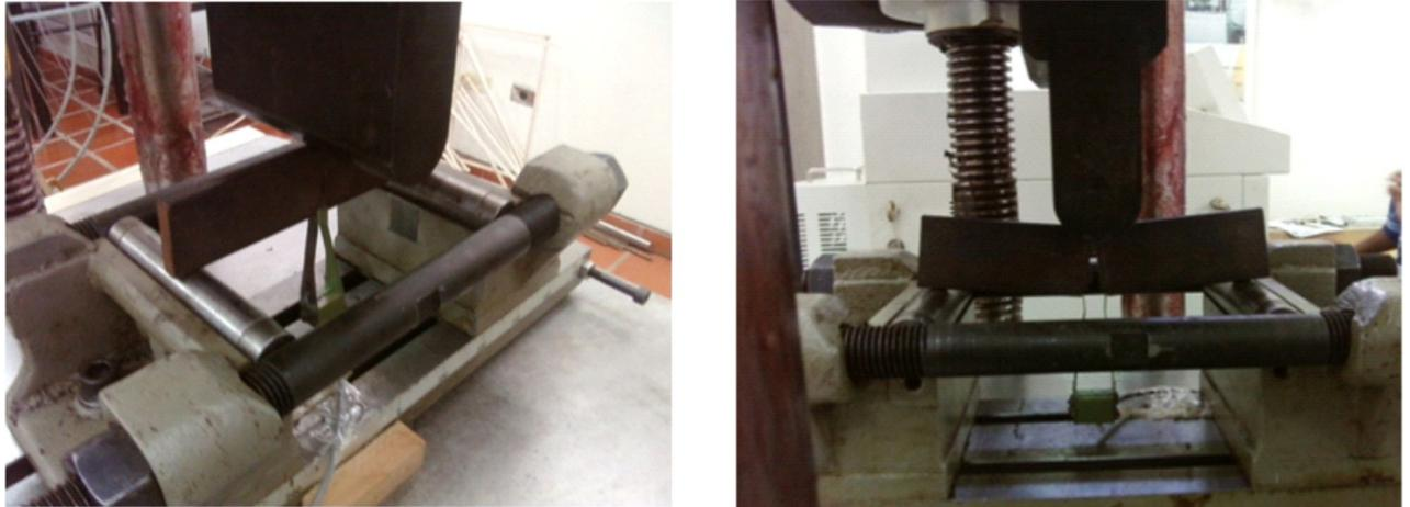
Figura 3.11: *Configuración de la prueba de dobléz para obtener la tenacidad de fractura*
