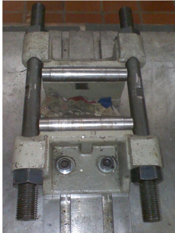
Figura 3.5: Soporte de rodillos para el montaje de la probeta.
