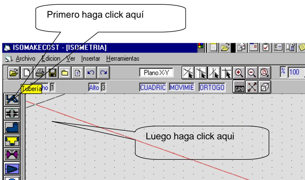
Desplace el puntero del Mouse y observará el despliegue de la tubería, para ubicar el punto final libere el botón del Mouse, inmediatamente presenta un cuadro de Propiedades de la Tubería.
