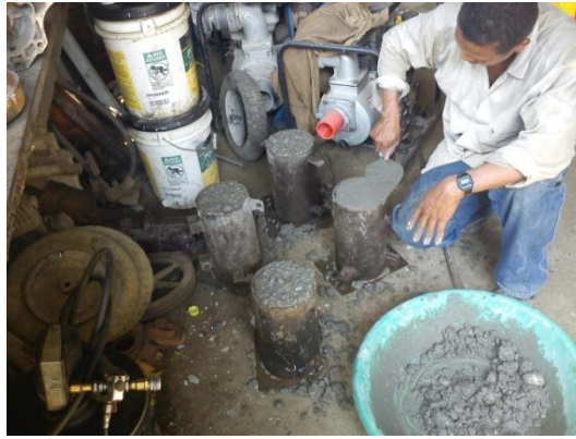
Figura 23. Enrazado Fuente: Tomado en Laboratorios de C.H. Pereira
