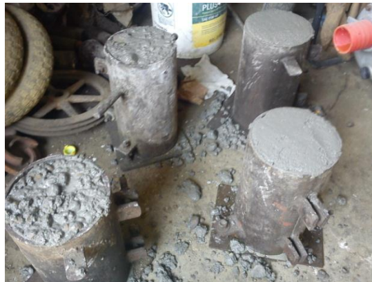
Figura 24 Enrazado de cilindros Fuente: Tomado en Laboratorios de C.H. Pereira
