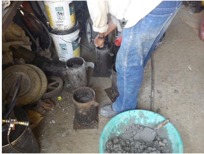
Figura 21. Vaciado en cilindros de mezcla Fuente: Tomado en Laboratorios de C.H. Pereira
