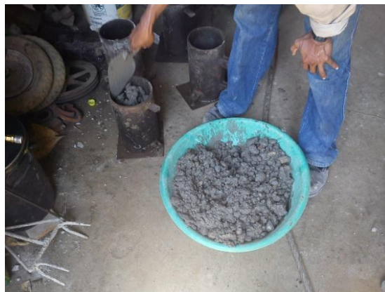
Figura 20. Limpieza y vaciado en cilindros Fuente: Tomado en Laboratorios de C.H. Pereira
