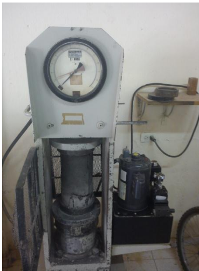
Figura 10. Maquina de compresión Fuente: Tomado Laboratorio C.H. Pereira
