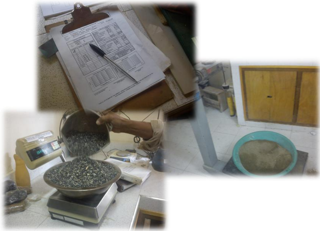
Figura 14. Determinación de las cantidades necesarias para muestras de cilindro Fuente: Tomado Laboratorio de C.H. Pereira
