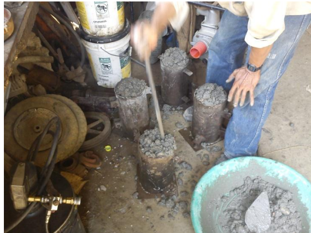
Figura 22. Compresión de la mezcla en moldes Fuente: Tomado en Laboratorios de C.H. Pereira
