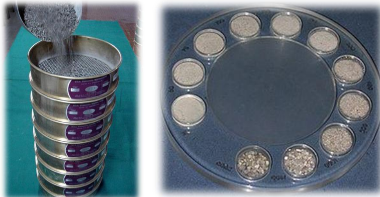
Figura 4. Tamices para análisis granulométrico Fuente: http://www2.ing.puc.cl/~ingeot/ice1603/lab3/lab3.htm
