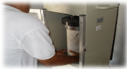
Foto 23: Colocación del cilindro.
