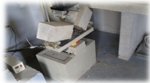
Foto 28: Momento de falla viga.
