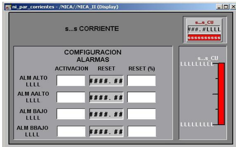
Figura 15. Pantalla de Parámetros Transmisores de Corriente
