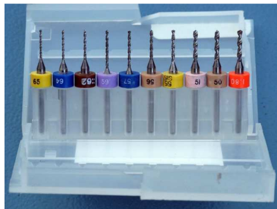
Figura 119. Fresas de carburo para perforación.
