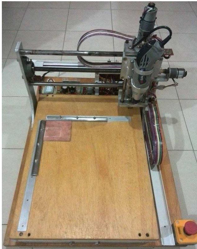
Figura 102. Maquina CNC con arquitectura funcional diseñada y construida en éste Trabajo de Grado.
