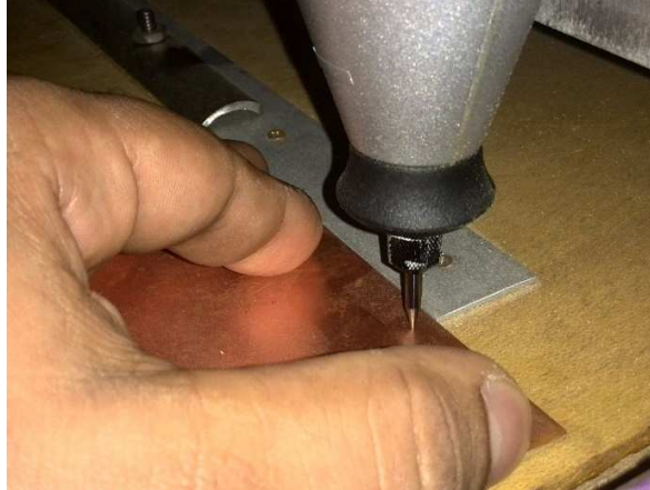
Figura 125. Uso de PCB virgen como calibrador de holgura.
