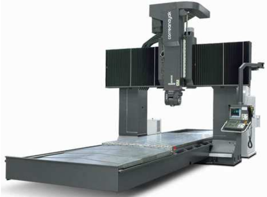
Figura 2. Fresadora pórtico (Correanayak, s.f.).
