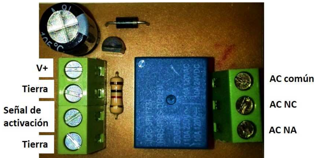
Figura 61. Implementación del accionamiento del efector final.
