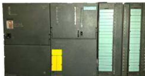
Figura 14. PLC Simatic S7-300 de Siemens.
