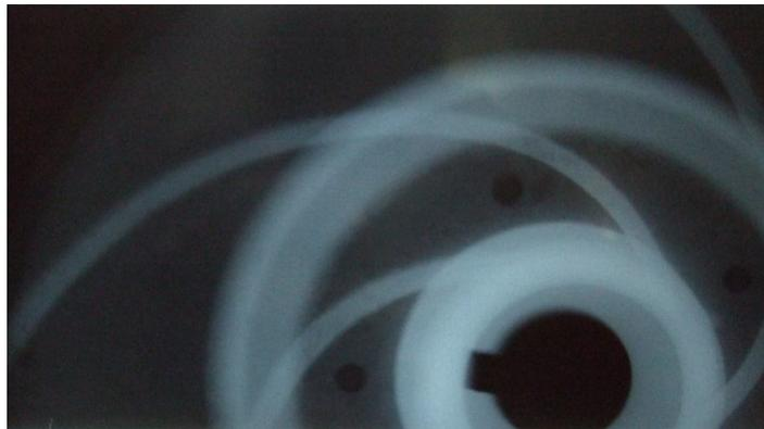
Figura 34 Gammagrafía del impelente
