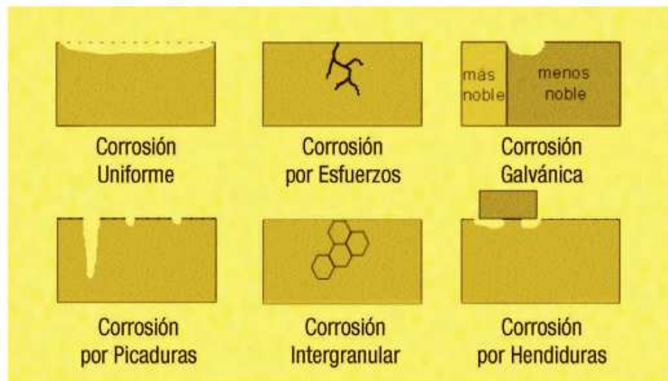
Figura 24. Algunos de los tipos de corrosión más comunes por influencia del medio, las estructuras y composiciones del metal
