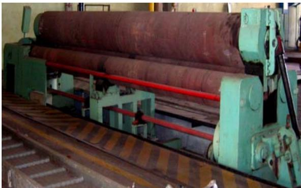
**Capacidad:  $\frac{3}{4}$ " de espesor, 6 m de ancho y radio mínimo 35 cm**
