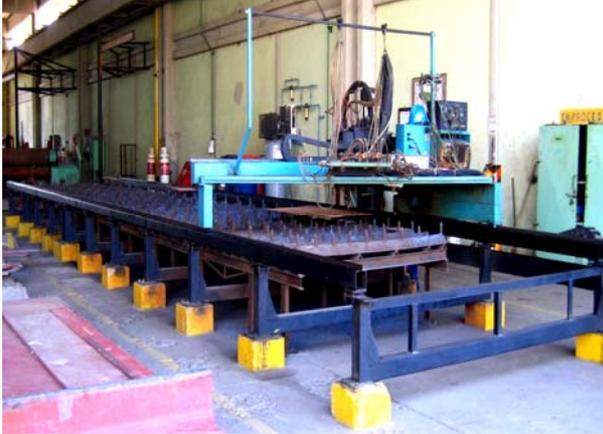
**Capacidad 2" x 8' x 20' en acero al carbono; equipo de plasma marca thermal dynamics pak 45, capacidad de corte 6" en acero, 5.5" en aluminio.**
