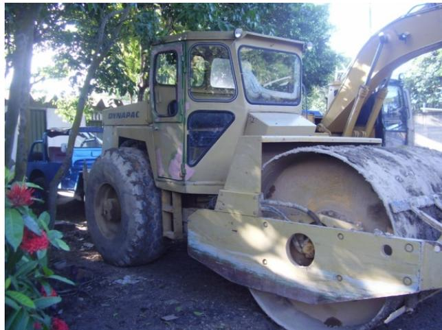
**Figura 9. Vibrocompactador.**
