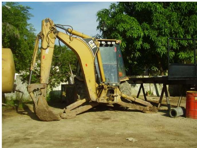
***Figura 3. Retroexcavadora.***
