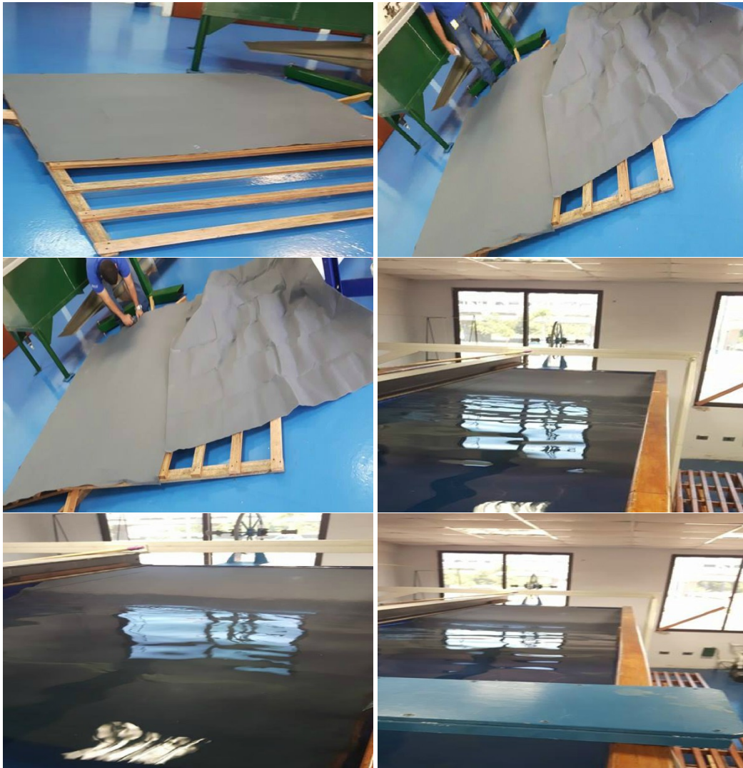
Figura 4-48: Proceso de Construcción e implementación del absorbedor de olas
