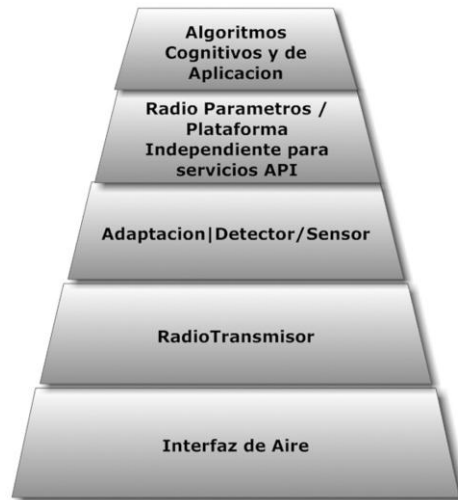
Figura 2.3. Modelo de un sistema de Radio Cognitivo. Fuente: http://bibliotecadigital.icesi.edu.co/biblioteca_digital/bitstream/item/5283/1/Revista%20S%26T%20Vol%209%20N%2016%20-%20Radio%20cognitiva.pdf
