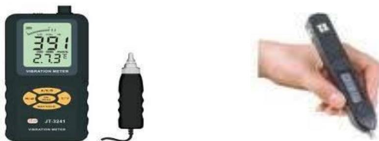
**Figura 6. Medidores de Vibración**
