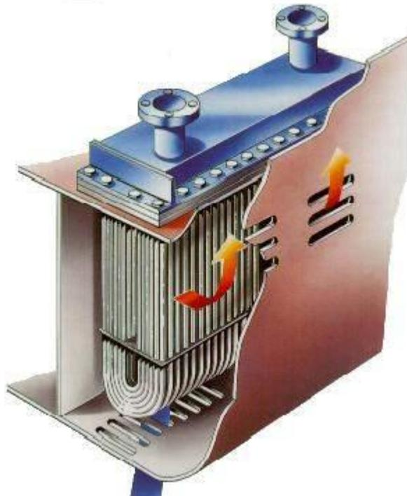
Fig. 2.1. Intercambiador de calor tipo Boxcooler
