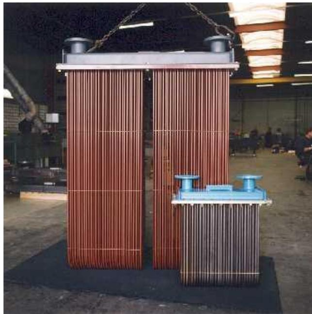
Fig. 2.5. Refrigerador para barcos con y sin revestimiento.
