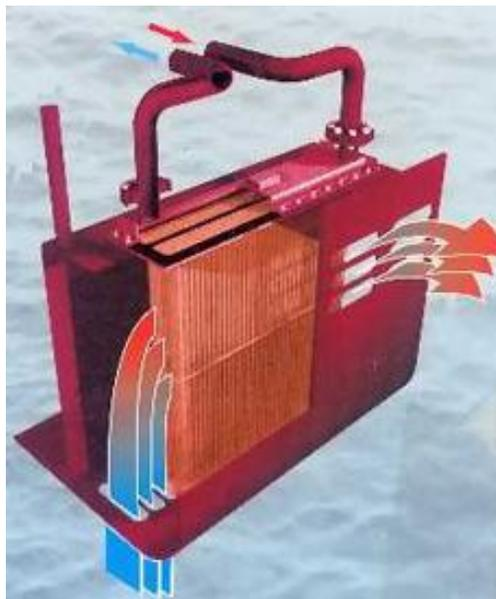
Fig. 2.2. Principio de funcionamiento del enfriador
