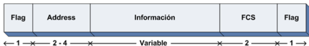
Figura 4. Formato de la trama Frame Relay. (Fuente: www.textoscientificos.com ).
